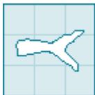
Der Riss zur rechten Seite zeigt für RH-Schützen eine steife Reaktion des Pfeilschafts an (für LH-Schützen geht der Riss aufgrund zu steifer Schäfte zur linken Seite). Zur Problembehebung: Zuggewicht anheben, schwere Spitze oder Insert verwenden, leichtere Sehne (weniger Stränge) verwenden, einen weicheren Pfeilschaft verwenden oder den Buttondruck (Federspannung) reduzieren bzw. eine weichere Feder einsetzen.
