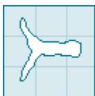
Der Riss zur linken Seite zeigt für RH-Schützen eine weiche Reaktion des Pfeilschafts oder „Clearance“-Probleme an (für LH-Schützen geht der Riss aufgrund zu steifer Schäfte zur rechten Seite). Zur Problembehebung: Clearance überprüfen, Zuggewicht reduzieren, leichtere Spitze oder Insert verwenden, schwerere Sehne (mehr Stränge) verwenden, einen steiferen Pfeilschaft verwenden oder den Buttondruck (Federspannung) anheben bzw. eine härtere Feder einsetzen.
