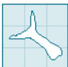
Dieser Riss zeigt eine Kombination von mehreren negativen Einflüssen auf den guten Pfeilflug an. Es gilt die oben beschriebenen Maßnahmen kombiniert durchzuführen, wobei die Ursache für den vertikalen Einriss (Nockpunkt-position oder Clearance) zuerst korrigiert werden muss, bevor die horizontale Ursache beseitigt wird.
