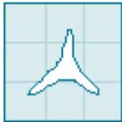
So sollte das entstandene Loch im Papier aussehen, wenn der Pfeil optimal zum verwendeten Bogen passt. Der Pfeil fliegt gerade durch das Papier, wobei Spitze und Befiederung im selben Loch das Papier einreißen. Dies ist eine ideale Abbildung, die in der Realität häufig nicht genau erreicht werden kann.
