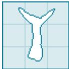
Dieser Riss zeigt einen zu hohen Nockpunkt oder Clearance Probleme an. Um dieses zu ändern, sollte der Nockpunkt um 1-2 mm nach unten versetzt werden. Man wiederholt diesen Vorgang so lange, bis der vertikale Riss nicht mehr auftritt. Sollte der Riss trotz versetzen des Nockpunktes nicht kleiner werden, so deutet dies auf ein Anstreifen des Pfeils am Mittelteil oder der Pfeilaufgabe hin. Siehe Kapitel „Clearance“ weiter oben, um das Problem zu beheben.
